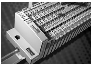
1999 г. – Контроллеры Ethernet TCP/IP (BK9000, BC9000), (USB) (BK9500), 16-битовые модули (KL31x2, KL41x2), мост сопротивлений (KL3351)
